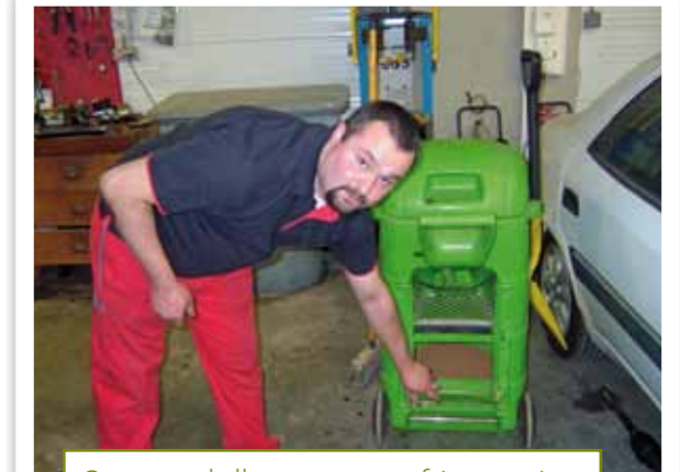
Cette « poubelle » verte est en fait un système qui tamise le sable souillé d'huile et permet de multiples réutilisations
