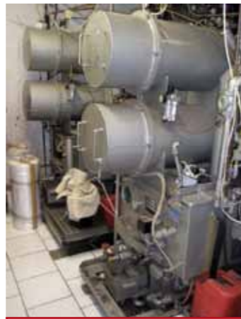
Machine de nettoyage à sec avec cartouches de filtration à la place du distillateur : économie d'eau et d'électricité garantie
